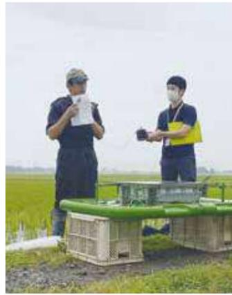
写真：自動抑草ロボット『アイガモロボ』
