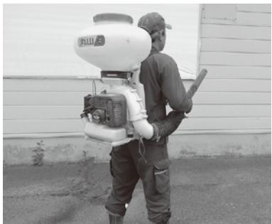
有機肥料・化学肥料・除草剤・粉剤などをホッパーに入れ散布する機械で、背負って使います。(エンジンの排気量によりホッパーは90~30ℓまである)エンジンでファンを回し、その風力を使って噴筒、またはホースで散布します。粒状の時は噴筒を長くするほど遠くまで散布できます。粉剤は穴の開いたホースを使って散布。同じ背負式で液剤を散布する機械(背負動噴)もあります。
