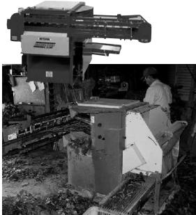
回転する二つの円筒の隙間を通らせ、莢を取ります。同時に風で葉を飛ばす仕組みですが、その後は人間の目で不良品を取り除きます。
